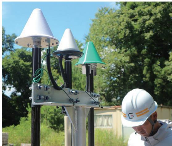
GNSSアンテナの性能試験
