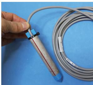
小型高精度傾斜センサ
