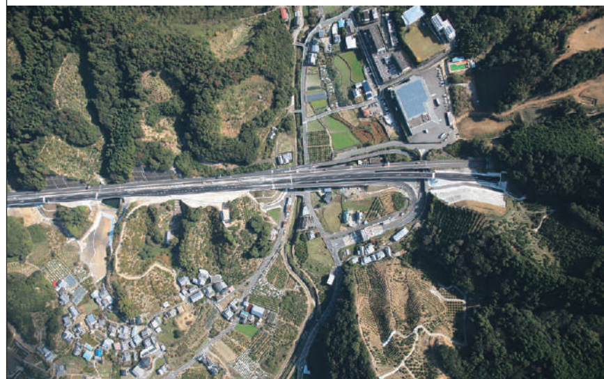
湯浅御坊道路柳瀬トンネル他1トンネル工事／和歌山県 発注者：西日本高速道路株式会社関西支社 ■概要：工事延長 L=2,139m。 トンネル延長 L=754m(湯浅トンネル L=621m、柳瀬トンネル L=133m) 橋梁下部工(橋台4基、橋脚8基) 基礎工(ベント杭φ1,200 L=60m、深礎杭φ2,500 L=15m) 既設橋撤去工1橋
